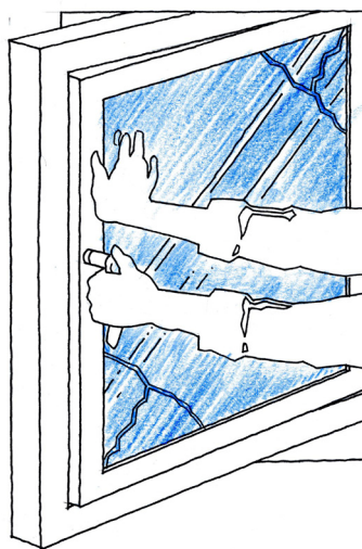
Figur 1. Skjuvning vid öppning/stängning av fönsterbåge
